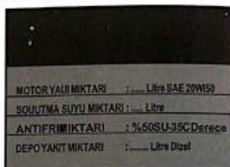
Jeneratörde kullanılması gereken motor yağı, soğutma suyu, antifriz miktarı ve yakıt deposu kapasite bilgileri yer alır.
